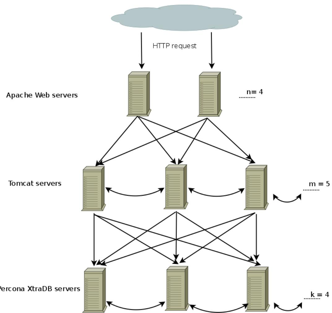
Слика1: Хардверска конфигурација сервера на производном окружењу
